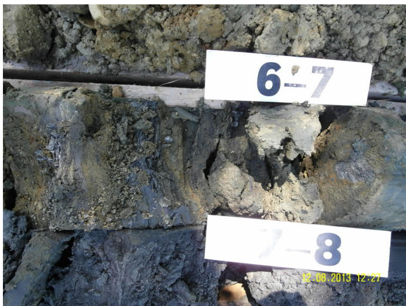
Fotografie 1: detail profilu "kanafasového souvrství" s uhelnými vložkami ve vrtném výnosu průzkumného objektu J1.
